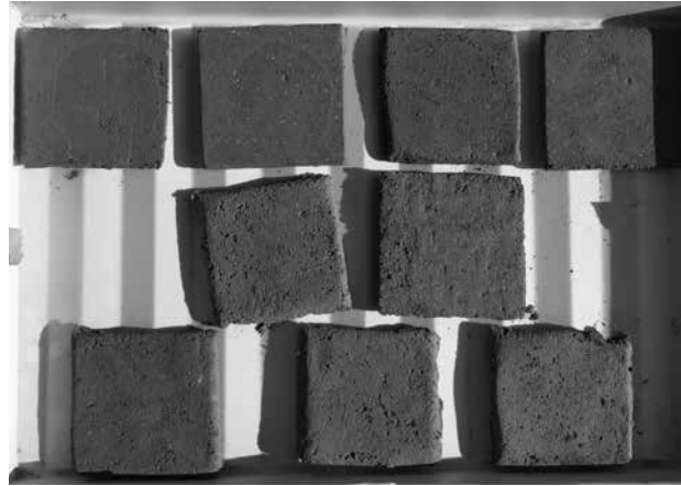
Figura 6. A las cinco horas del experimento, las placas que aparecen en la parte inferior de la foto –y que fueron amasadas con agua– ya estaban prácticamente secas mientras que las cuatro superiores todavía se notan oscuras por su estado húmedo. Fuente: Guerrero (2015).
