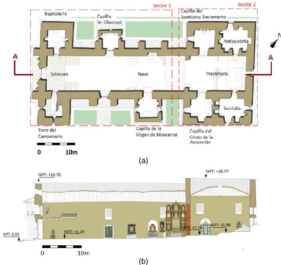
Figura 2. Detalles de la arquitectura de la Iglesia: (a) plano en planta; y (b) corte longitudinal A-A (Adaptado de Castillo et al 2012)
