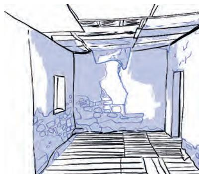
Revestimiento interior, grietas, humedad, desprendimientos de material.
