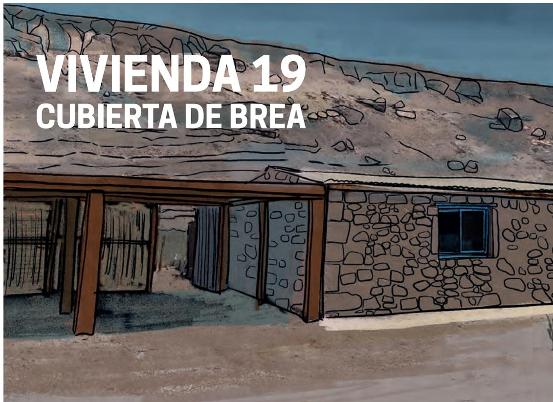
Ilustración vivienda 19, mampostería de piedra y cubierta de brea.
