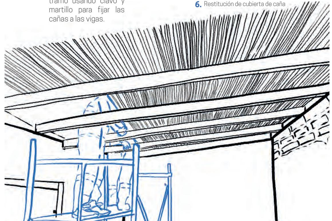
Una vez restituida la cubierta de caña, se debe colocar una cubierta de barro sobre esta.
