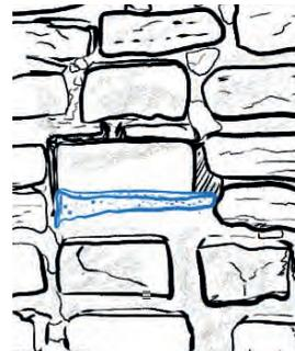
**4.** Rellenar la parte inferior con mezcla de cal, arena y tierra, en una proporción de 30% de arena 10% de cal y 10% de tierra de Caspana.
