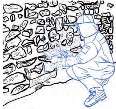
**2.** Una vez adherido el mortero, corregir las imperfecciones que se hayan generado y emparejar la superficie con una esponja o brocha, utilizando movimientos suaves para obtener una terminación prolija.
