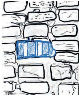
**3.** Dentro de ese vacío se colocan unos tacos de madera que sirvan como apoyo mientras no reemplazamos el adobe faltante.
