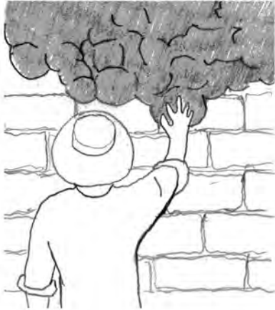
Lanzar con fuerza bolas de barro sobre el muro y apretarlas con las manos.
